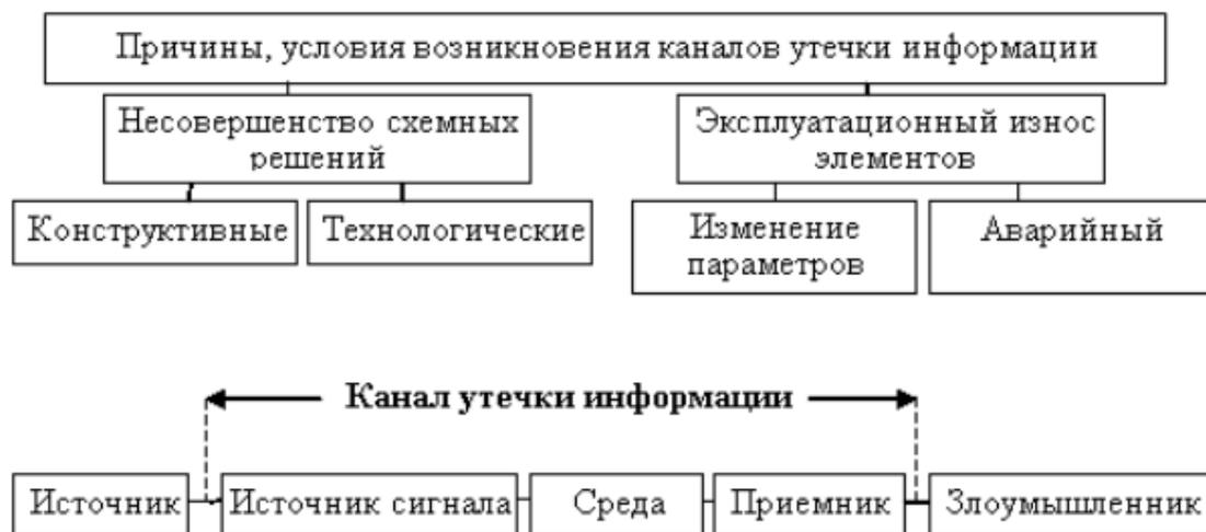
Рисунок 1 – Причины образования канала утечки информации по линиям электропитания
