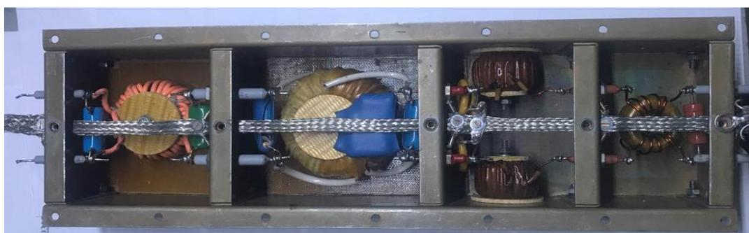
Рисунок 3.3 – Вид сверху на сетевой фильтр
