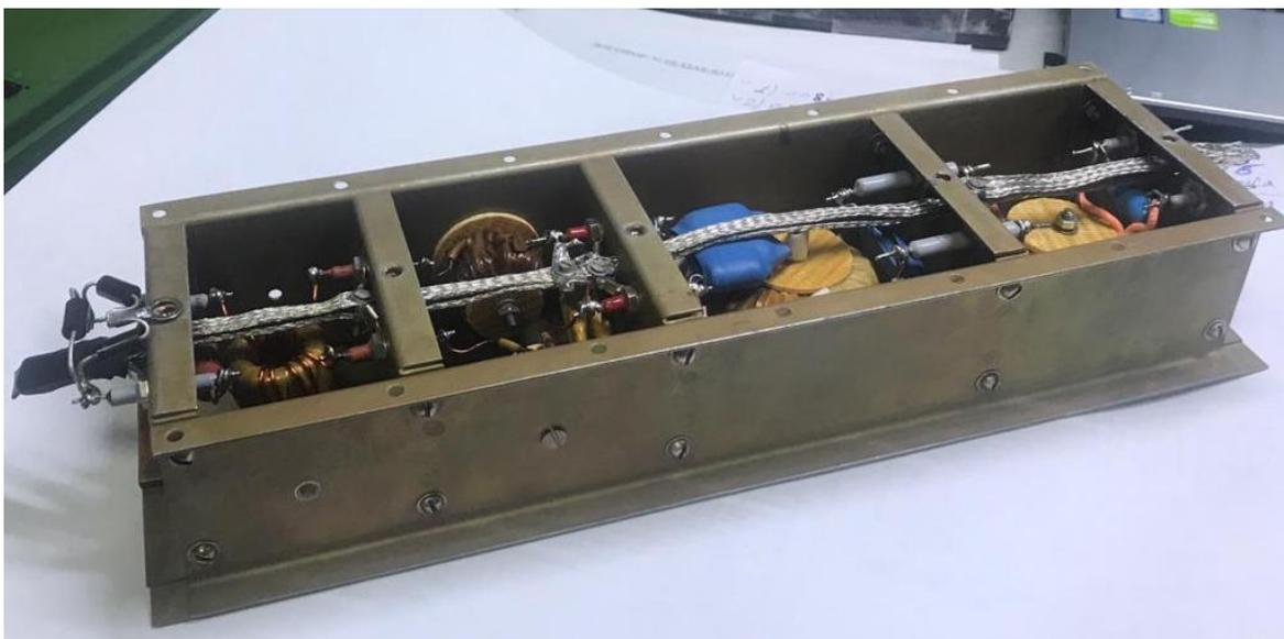
Рисунок 3.2 – Физическая реализация сетевого фильтра
